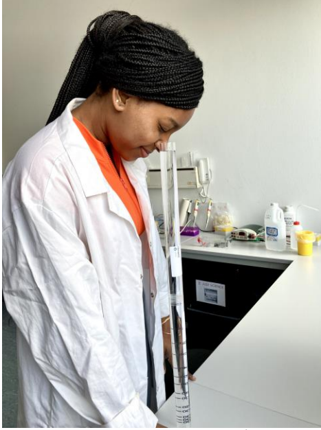
الشكل 1 - أنبوب التعكر هو أداة سهلة الاستخدام للغاية لقياس تعكر عينات المياه
